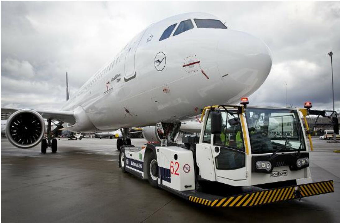
2. ábra: Orrfutókereket megemelő „PHOENIX E” Goldhofer vontató
